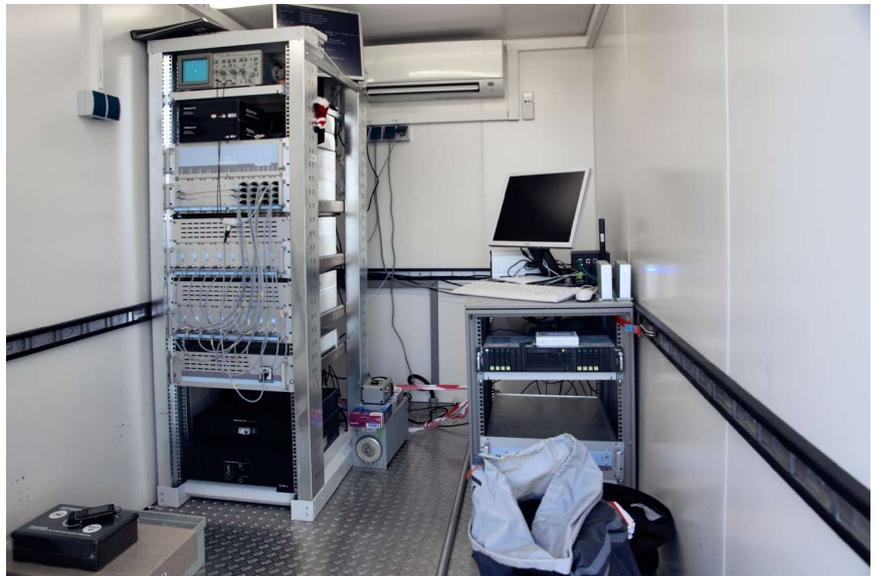
WERA-Radarsystem mit Empfängern, Prozessrechnern und dem Multichannel VPN Router (rechts hinten)
