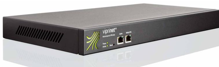
Der Multichannel VPN Hub dient als VPN-Konzentrator für die von den Multichannel VPN Routern aufgebauten VPN-Tunnel, mit denen Daten über mehrere gebündelte Breitbandanschlüsse versendet werden können. Terminiert werden diese Bündel dann in Sternstruktur mittels eines Multichannel VPN Hub in einem Rechenzentrum. Dort werden die Daten entschlüsselt und an ihr Ziel weitergeleitet.
