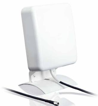
Les signaux 3G / UMTS sont souvent faibles dans les bâtiments. Cette antenne extérieure vient en aide. Dans son boîtier stable et résistant aux intempéries, un récepteur ultra-large bande est installé permettant un gain jusqu'à 11 dBi. L'antenne peut se fixer sur paroi ou sur mât; elle doit être dirigée vers l'émetteur de l'opérateur de téléphonie mobile utilisé.
